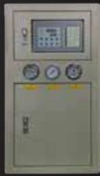
提供恒温、恒压水的装置，用以冷却焊枪。该水箱的制冷能力为5000大卡，温度设定范围+5°C~+35°C，精度为±1.0°C，水箱容积为35升，制冷剂为R22。
